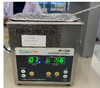
Gambar 1. Rangkaian alat ekstraksi oleoresin lada hitam menggunakan metode ultrasound assisted extraction BAKU Tank BK-1200
