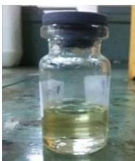
**Gambar 4.b.** Gliserol hasil samping trans-esterifikasi Hasil transesterifikasi 40 gram minyak sawit dengan metanol dikatalis CaO-MgO dihasilkan campuran metil ester sebesar 33,27 gram dengan rendemen 85,72 %.
