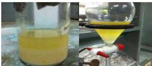
**Gambar 3.** Hasil trans-esterifikasi dengan metanol
