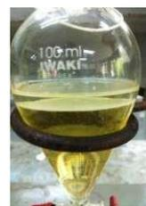
**Gambar 5.** Hasil transesterifikasi dengan etanol
